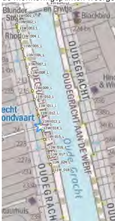
Figuur 2: locaties prisma's aan werfmuur rak 10 west
